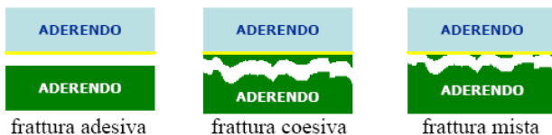
Figura 2-10 – Confronto tra le diverse tipologie di frattura.
